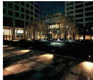
④片側配光タイプのポラード照明 指向性のあるポラード照明は地面を明るく照らしたい場合に適している。光源がむき出しになっているタイプはグレアとなるため、遮光がされたものが望ましい。器具の高さは30～100センチ程度が一般的。場所のスケールに合わせてサイズを選定する。
