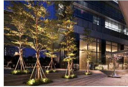
スパイク式スポットライトによる樹木照明の事例
