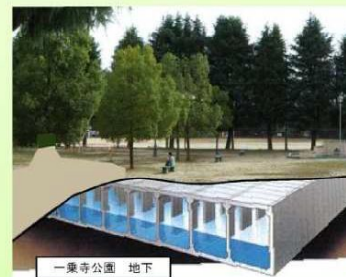
対策イメージ(貯留施設の設置) 普通河川 第二太田川の(例)
